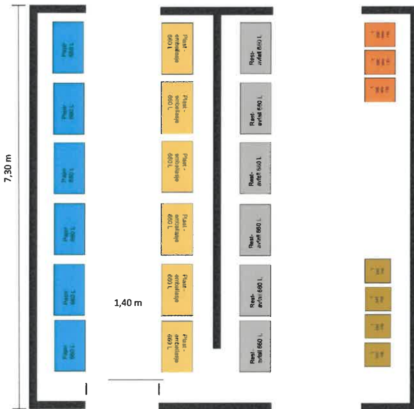
Figur 5: Prinsipp avfallsrom / avfallshus ved fire rekkjer
